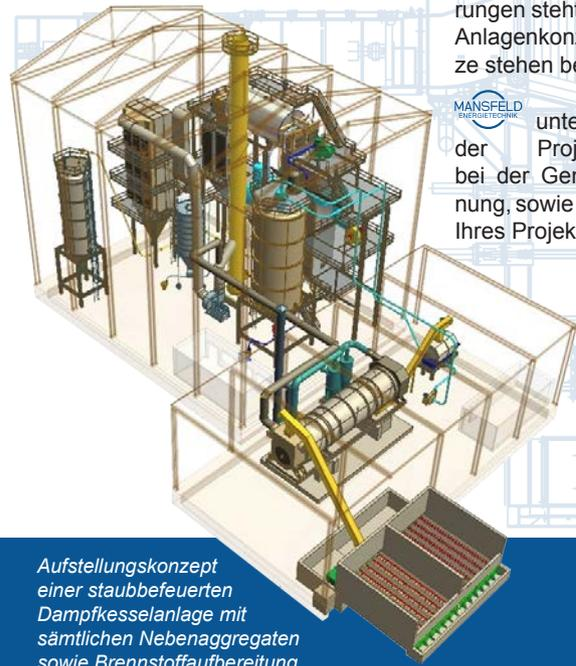
Aufstellungskonzept einer staubbefeuerten Dampfkesselanlage mit sämtlichen Nebenaggregaten sowie Brennstoffaufbereitung
